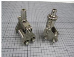
Abb. 2: Vorrichtungen zu Rollenschälversuchen nach DIN EN ISO 1464 (rechts) und PV2034 (links).
