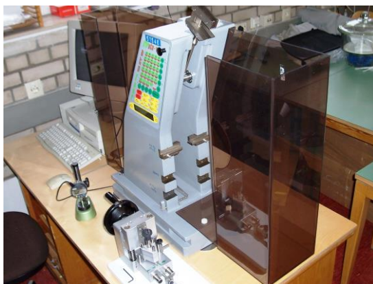
Abb. 1: Schlagprüfmaschine und Universalprüfmaschine mit Temperiereinheit
