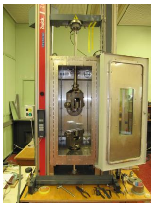
Abb. 1: Schlagprüfmaschine und Universalprüfmaschine mit Temperiereinheit
