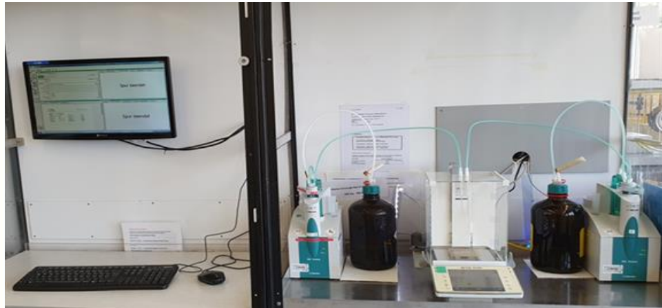
Abb. 2: Automatisiertes Probenvorbereitungssystem; üblich sind Polymerkonzentrationen von 0,005 \text{ g/cm}^3 (0,5 %) und 0,01 \text{ g/cm}^3 (1 %).
