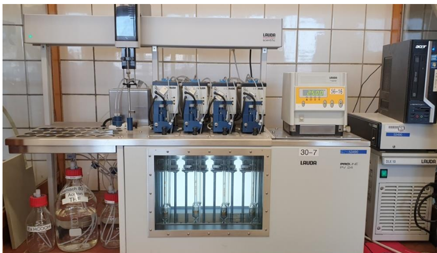
Abb. 1: Vollautomatisches Lösungviskositäts-Messsystem; erlaubt die schnelle Bearbeitung großer Probenserien.
