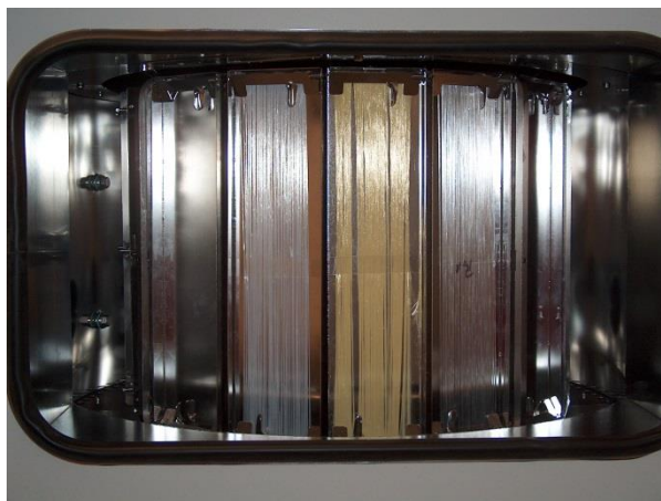
Abb. 2: Xenotest Beta – Detailansicht auf Probenhalterkarussell mit senkrecht gespannten Fäden.
