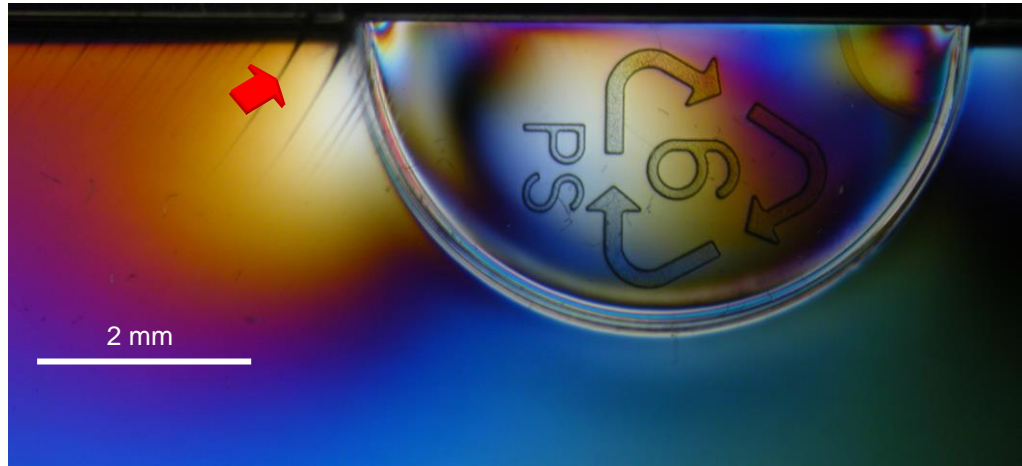
Abb. 3: Beginnende Spannungsrissbildung durch Alkohol.
