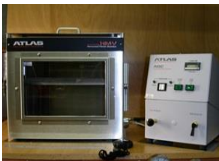
Abb. 2: Brennkammer mit Kontrolleinheit.
