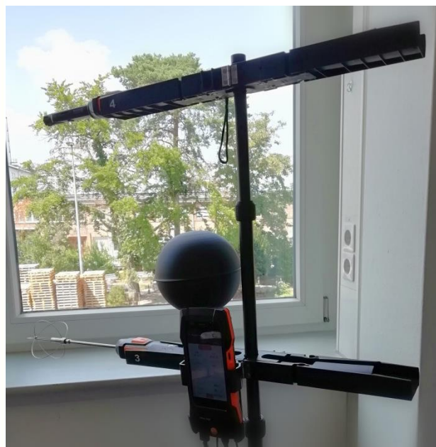
Abbildung 2: Messaufbau für die Behaglichkeitsmessung. Oben auf dem Stativ befindet sich der Sensor für Luftfeuchte, Temperatur und CO 2 . Unten sind die Globe-Sonde, die Turbulenzgradsonde, sowie das Aufzeichnungsgerät angebracht.
