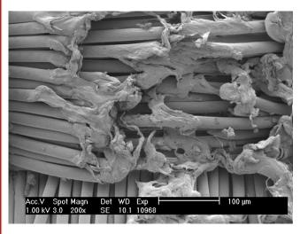
Dieses Schadensbild in der Nähe einer Fehlstelle deutet auf einen thermisch-mechanischen Kontakt hin, wie er etwa bei starker Reibung und hoher Geschwindigkeit auftritt. Zur Vermeidung solcher Beschädigungen sind häufig konstruktive Veränderungen am Modul notwendig.
