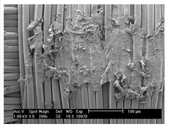
Bei diesem Schadensbild handelt es sich nur um eine ,harmlose' Auflagerung durch den Kontakt mit der Polymerkappe. Eine Schädigung der Filamente hat kaum stattgefunden, so dass die Funktion des Luftsacks nicht beeinträchtigt ist.
