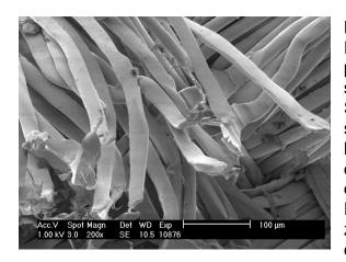
Hier wurden die Fäden am Rand der Fehlstelle plattgedrückt und vielfach sogar durchtrennt. Das Schadensbild deutet auf starke mechanische Einwirkungen hin und ist eindeutig dem Prozess der Herstellung oder Montage zuzuordnen. Folglich ist in solchen Fällen zu prüfen, an welcher Stelle des Prozesses große Kräfte auf das Gewebe einwirken.
