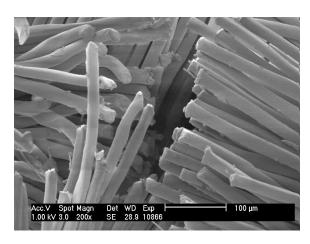
Die Filamentenden dieser Fehlstelle sind glatt durchtrennt, wobei alle Filamente die gleiche Länge besitzen. Die Fehlstelle wurde durch einen scharfen Schnitt verursacht. Der Herstellungsprozess ist somit nach scharfkantigen Bauteilen abzusuchen. März 2004
